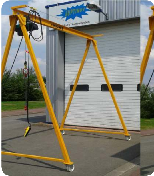
Portique roulant avec palan électrique
