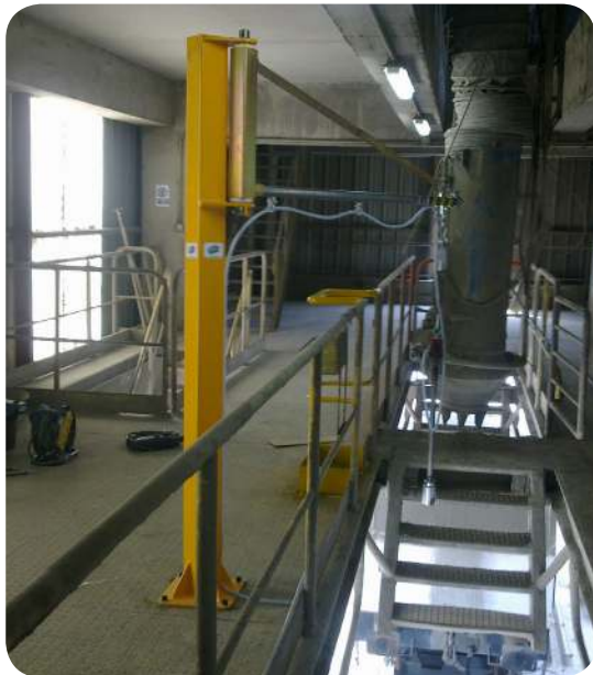
Fourniture et pose d'une potence sur mesure
