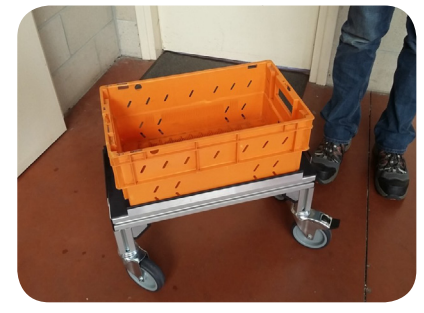
Rouleur sur-mesure en profilés aluminium pour bac LA POSTE
