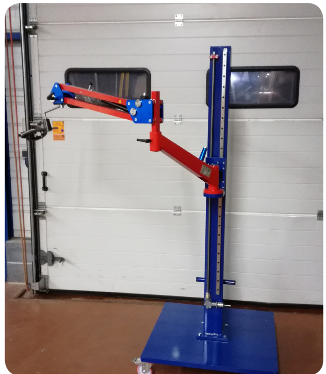
Bras auto-équilibré sur potence réglable en hauteur
