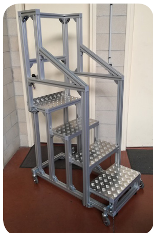
Marchepieds en profilés modulaires sur roulettes autobloquantes
