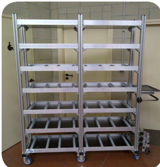
Etagère mobile avec rails à galets
