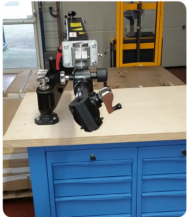
Bras support 3D monté sur établi mobile
