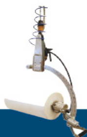
Outil de prise par mandrin avec rotation manuelle
