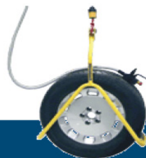
Outil pour pneu, utilisation sur palan
