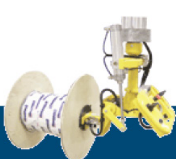
Outil de prise par le mandrin et inclinaison
